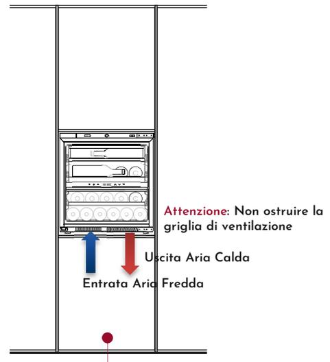
Il modelli **Autoventilati** integrano un sistema che permette l'ingresso e la fuoriuscita dell'aria tramite una **griglia frontale** posta dietro la porta della cantina, facilitandone l'installazione.
