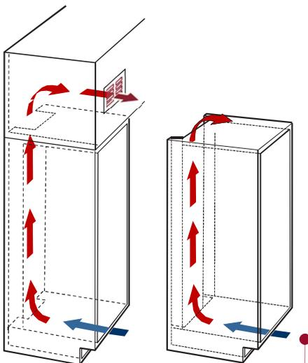
Per un corretto funzionamento della cantina è necessario prevedere una **Griglia frontale di ventilazione** sullo zoccolo, insieme al **camino di areazione posteriore** sul fondo del mobile per l'espulsione dell'aria calda
