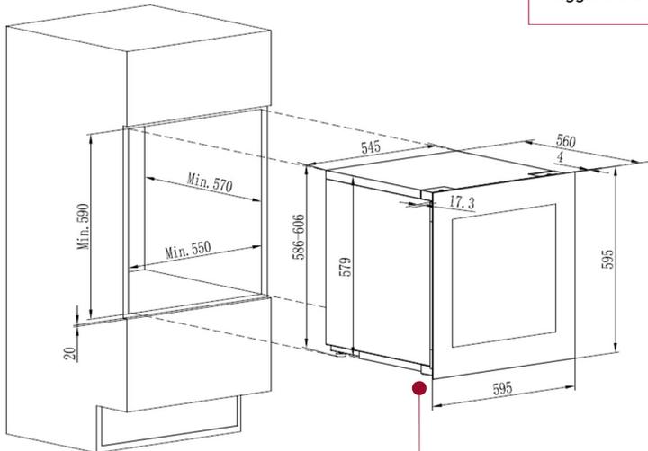
Dettaglio Misure per la realizzazione dell'anta porta della versione Pannellabile
